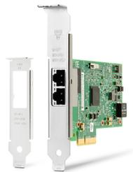
NIC PCIe gigabit de cobre y puerto doble I350-T2 ofrece dos puertos con alta velocidad de transferencia Ethernet de 10/100/1000 Mbps en una única ranura PCIe x4.
